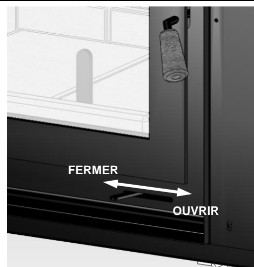
Figure 2 Contrôle d'air de combustion
